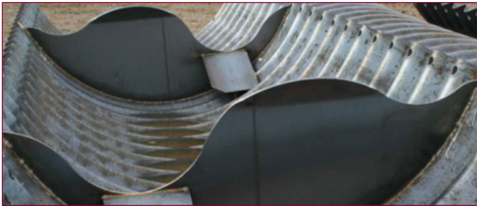
Des chicanes Duguay-Hannaford avant que l'acier soit recouvert par le revêtement en polymère (Photo offerte gracieusement par l'ITTO)
